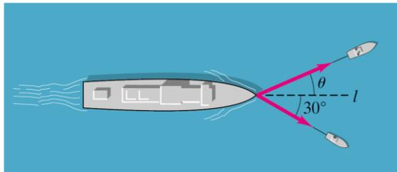
Le remorqueur le plus puissant génère une force d'intensité de 20'000 N sur un câble, le plus petit de 16'000 N. Si le navire suit une ligne droite  $l$ , calculer l'angle que forme le plus puissant des remorqueurs avec la droite  $l$ .
